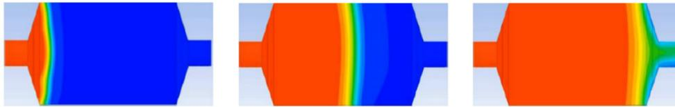
Abbildung 1: Drei Schritte der Beladung (rot=heiß, blau=kalt) des ETES-Wärmespeichers
